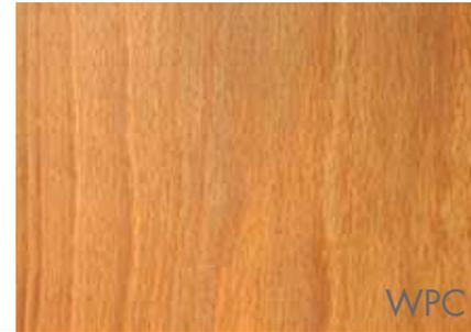
WPC (Wood Plastic Composite) ist ein Holz-Kunststoff-Verbundwerkstoff, der besonders langlebig ist (Dauerhaftigkeitsklasse 1). Dabei handelt es sich um eine moderne Holz-Polymer-Verbindung, die zu 40% bis 70% aus Holz besteht. Es ist der perfekte Werkstoff für den Außenbereich, z.B. für Terrassendielen.
