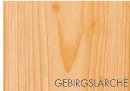
Lärche ist eine für den Außenbereich altbewährte Holzart. Sie zählt zu den Nadelhölzern. Sie ist mäßig witterungsbeständig und kann daher ohne zusätzlichen Oberflächenschutz gut im Außenbereiche eingesetzt werden.
